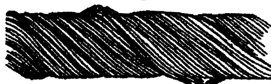
Рисунок 2. Сочетание обрывов проволок с их износом:
