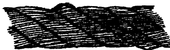
Рисунок 1. Обрывы и смещения проволок каната крестовой свивки.
