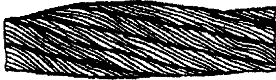
Рисунок 13. Местное увеличение диаметра каната.
